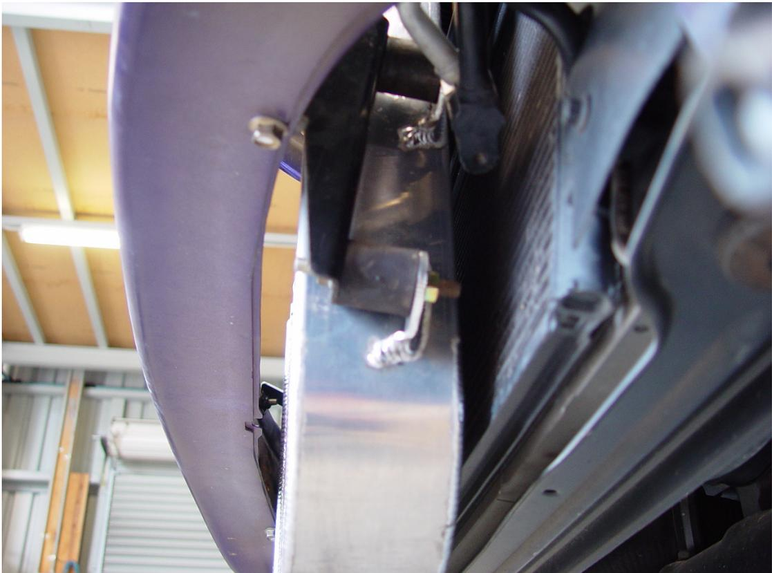
**10. FITTING OF THE 100MM X 2.25" SILICON SUPPLIED. USING THE ORIGINAL CLAMPS ENSURE THE TENSIONING SCREW IS REARWARD OF THE SILICON JOIN TO ALLOW CLEARANCE FOR HEADLIGHT BASE AS PICTURED BELOW.**
