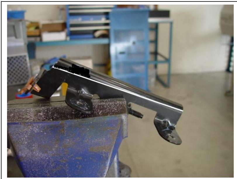
**9. PROCEED TO SCREW THE 2 RUBBER STAYS INTO THE LEFT HAND (PASSENGER SIDE) TANK. FASTEN THE M8 NUTS ON THE OPPOSITE ENDS OF RUBBER STAYS TO THE TRIMMED ORIGINAL BRACKET.**
